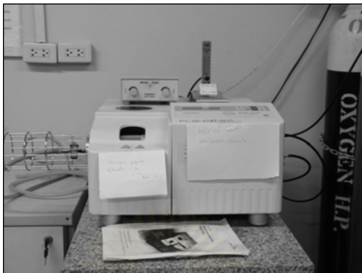
รูปที่ 3.8 เครื่องเทอร์โมกราวิเมตรีแอนาไลเซอร์
