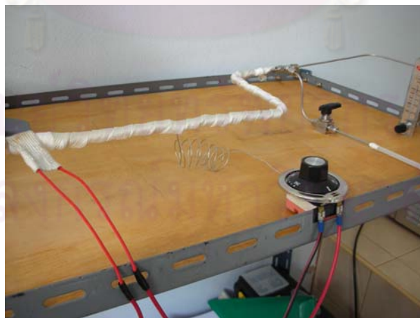
รูปที่ ค-6 เครื่องควบคุมอุณหภูมิ
