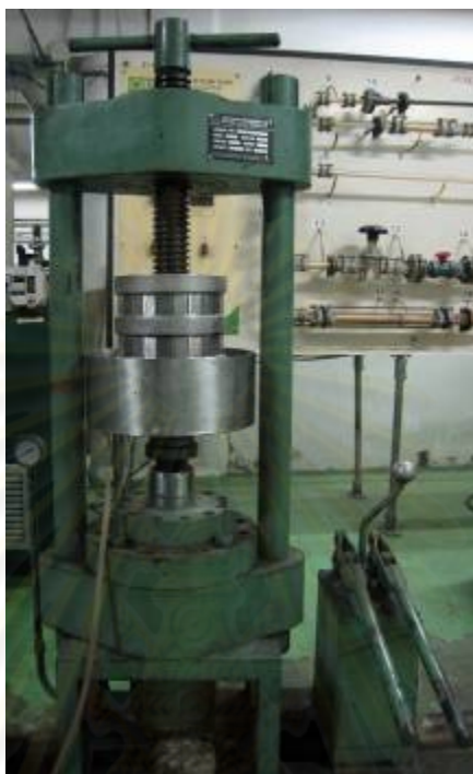
รูปที่ จ.1 เครื่องบีบอัดไฮดรอลิกที่ใช้ในการบีบน้ำมันออกจากเมล็ดคาเดเมีย
