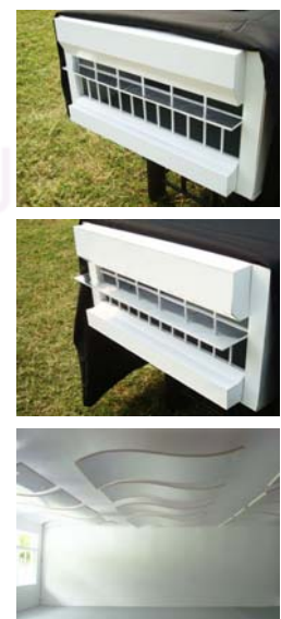
ภาพที่ 6.4 แสดงรูปแบบช่องเปิดทิศเหนือ-ใต้ที่มีการใช้ interior daylighting panels โค้งร่วมกับ light shelves ที่ช่องเปิดแบบเรียบตรง
