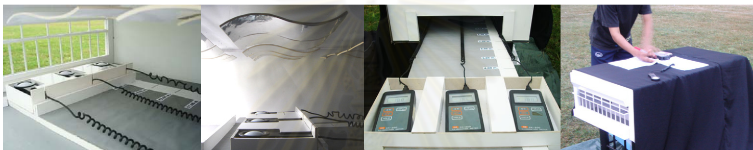
ภาพที่ 3.6 แสดงวิธีการเก็บข้อมูลค่าความส่องสว่างด้วยอุปกรณ์วัดแสง illuminance meter
