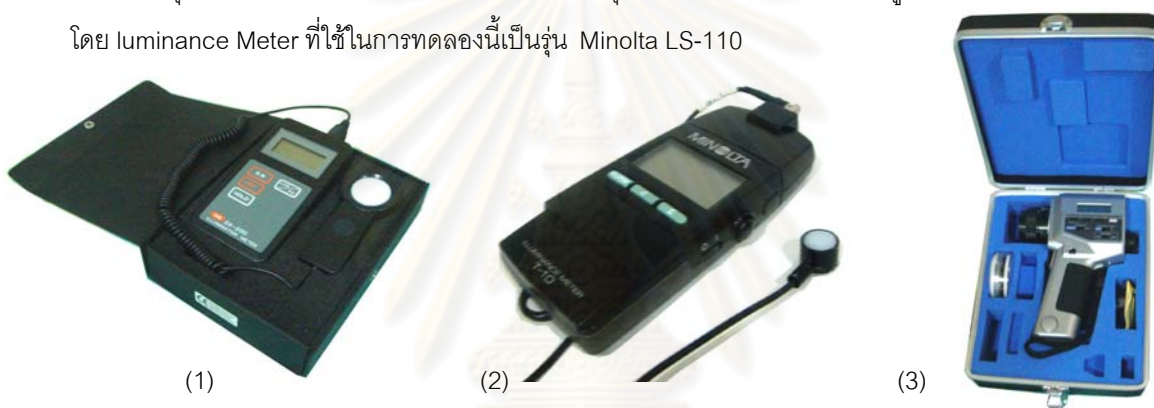
ภาพที่ 3.4 แสดงอุปกรณ์ / เครื่องมือในการทดลองประกอบด้วย 1) Lux meter รุ่น DX-200, 2) Lux meter รุ่น Minolta T - 10 และ 3) luminance Meter รุ่น Minolta LS-110 ตามลำดับ
