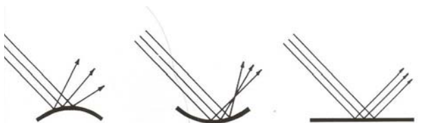
ภาพที่ 2.39 แสดงลักษณะของรูปทรงที่มีผลกับรูปแบบการสะท้อนแสง ( Lechner,2001 : 382)
