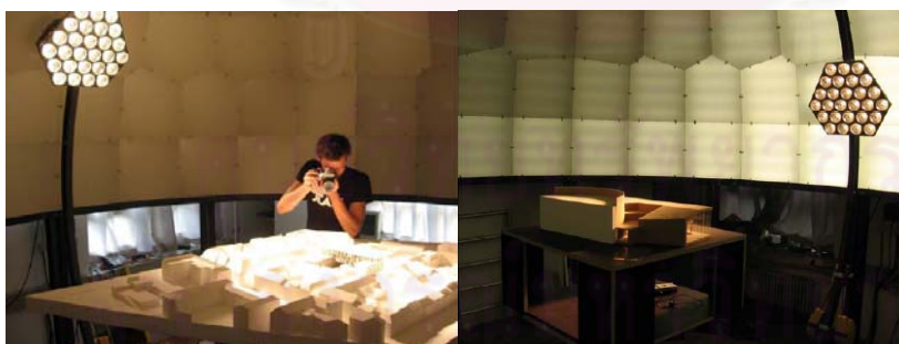
ภาพที่ 2.23 การวัดปริมาณความสว่างภายใต้ sky dome or artificial sky ( fbta,2009)
