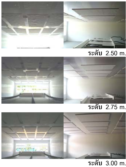
แผนภูมิที่ 4.65 กราฟแสดงผลการทดลองระดับ lighting panels เรียบระนาบนอน วัสดุ diffuse reflect. ได้สภาพท้องฟ้า overcast sky
