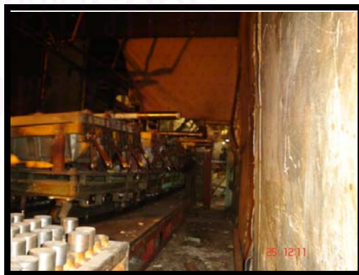
รูปที่ 4.9 การที่แม่พิมพ์เคลื่อนเข้าสู่เตาอบเพื่อเพิ่มอุณหภูมิแม่พิมพ์ให้สูงขึ้น
