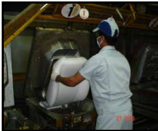
รูปที่ 4.11 แสดงการดึงชิ้นงานออกจากแม่พิมพ์ กรณีที่ชิ้นงานติดอยู่ที่ฝาแม่พิมพ์
