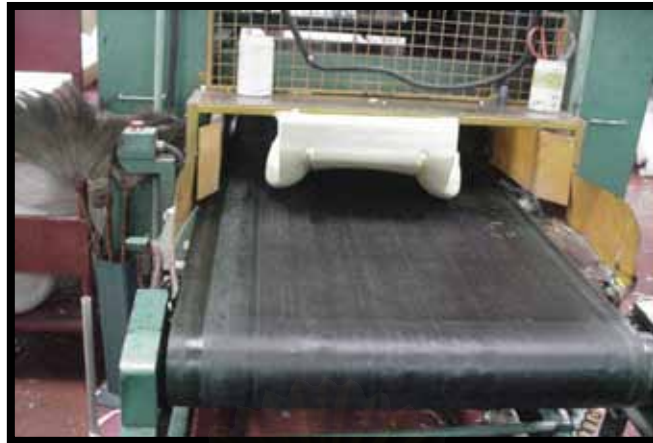
รูปที่ 4.13 การไล่แก๊สโดยใช้ Crushing roller
