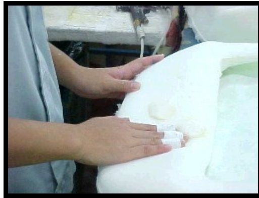
รูปที่ 4.16 การฉีดกาวที่แผลซ่อมและการติดโฟมซ่อมที่แผลซ่อมบนชิ้นงาน
