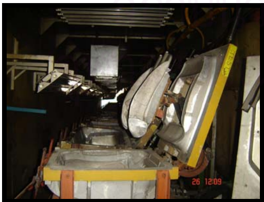
รูปที่ 4.9 การที่แม่พิมพ์เคลื่อนเข้าสู่เตาอบเพื่อเพิ่มอุณหภูมิแม่พิมพ์ให้สูงขึ้น
