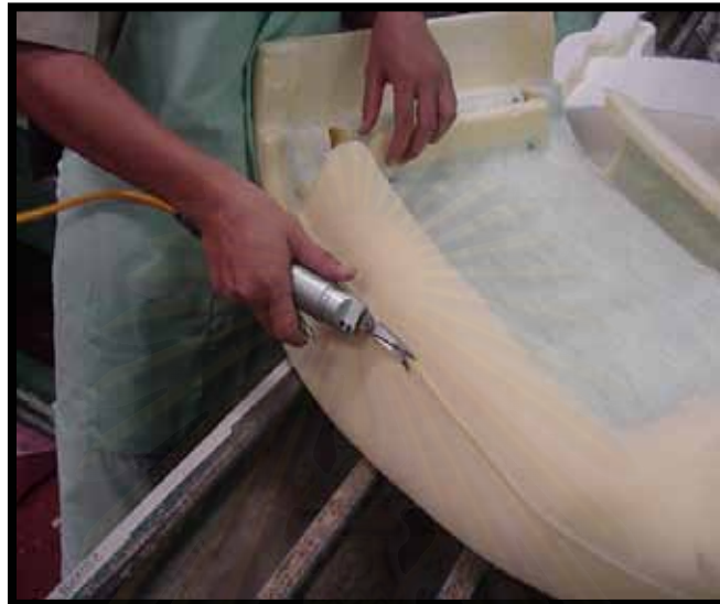
รูปที่ 4.12 การใช้กรรไกรลมตัดเศษโฟมตามขอบชิ้นงาน
