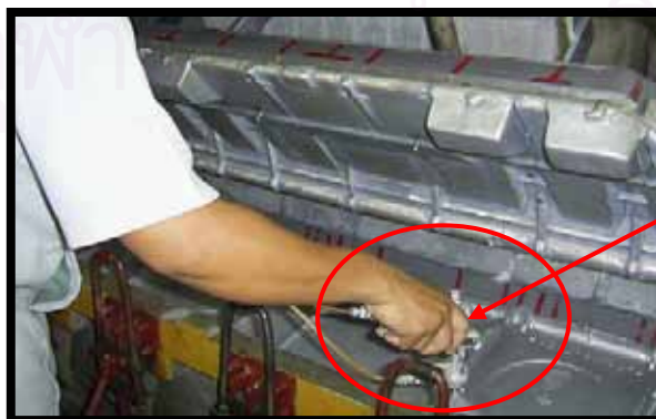
รูปที่ 4.5 การฉีด แวกซ์ ลงบนแม่พิมพ์
