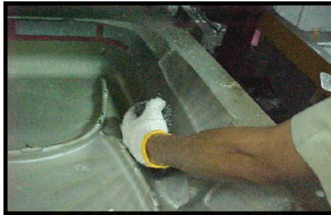
รูปที่ 4.3 การทำความสะอาดแนวขอบแม่พิมพ์
