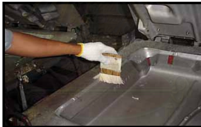
รูปที่ 4.4 การทำ แวกซ์ ตามแนวขอบแม่พิมพ์
