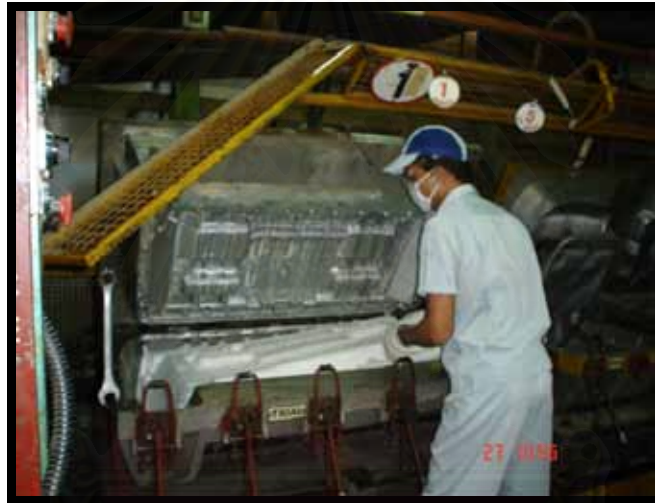
รูปที่ 4.10 การดึงชิ้นงานออกจากแม่พิมพ์ กรณีที่ชิ้นงานติดอยู่ที่ตัวแม่พิมพ์
