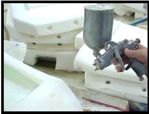
รูปที่ 4.16 การฉีดกาวที่แผลซ่อมและการติดโฟมซ่อมที่แผลซ่อมบนชิ้นงาน
