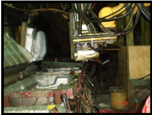
รูปที่ 4.8 การฉีดสารเคมีลงแม่พิมพ์
