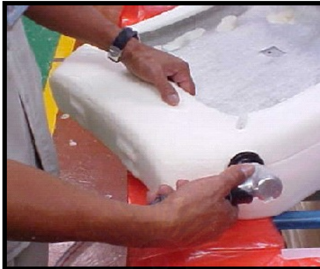
รูปที่ 4.18 การเจาะระโนบริเวณที่เป็นแผลซ่อมของชิ้นงาน
