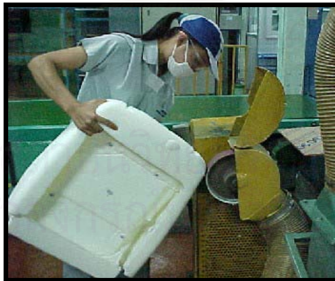
รูปที่ 4.17 การเจียรระโนตามแนวขอบของชิ้นงาน
