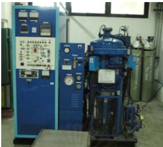
รูปที่ 3.3 เตาเผาควบคุมบรรยากาศ (High-Multi 5000, FV PHP-R-5, FRET-25)
