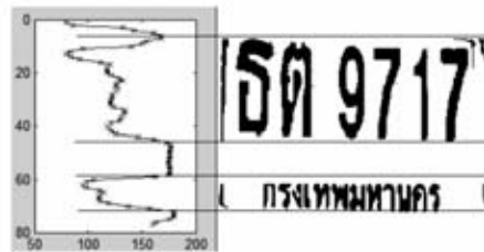
รูปที่ 3 การฉายจุดภาพในแนวนอนเพื่อแยกส่วนที่เป็นเลขทะเบียนและชื่อจังหวัด
