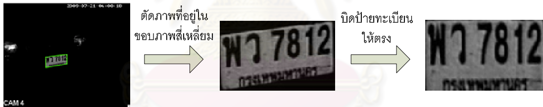
รูปที่ 19 การประมวลผลภาพในขั้นตอนต่างๆ เพื่อสกัดภาพป้ายทะเบียนรถยนต์
