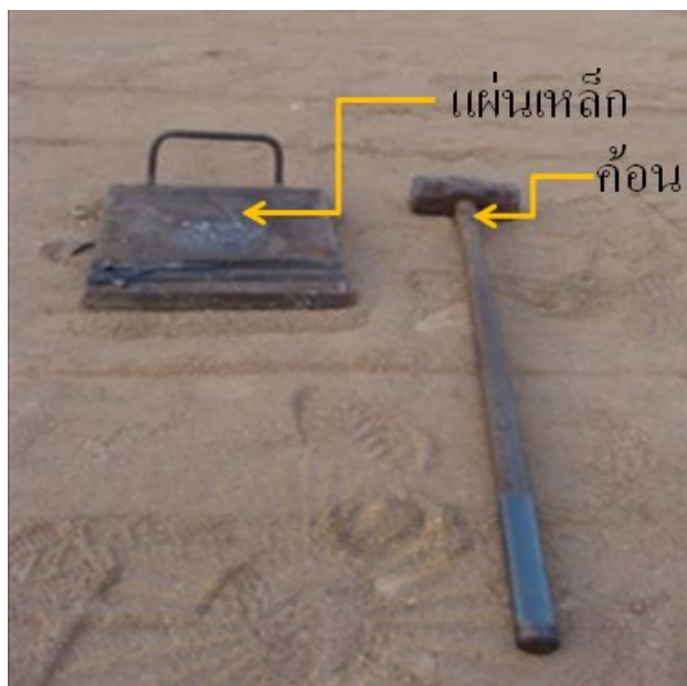
ภาพที่ 3.4 อุปกรณ์ที่ทำให้เกิดสัญญาณคลื่นสั่นสะเทือน
