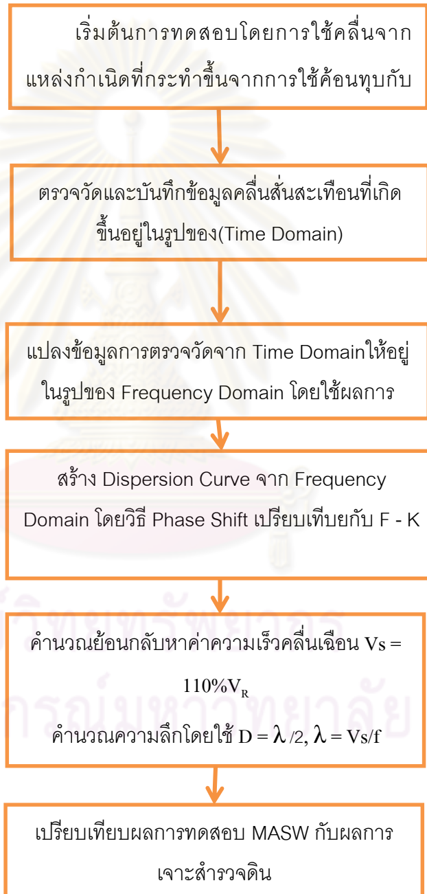
ภาพที่ 3.1 Flow chart แสดงขั้นตอนวิธีการดำเนินงานของวิธีทดสอบแบบแอกทีฟ
