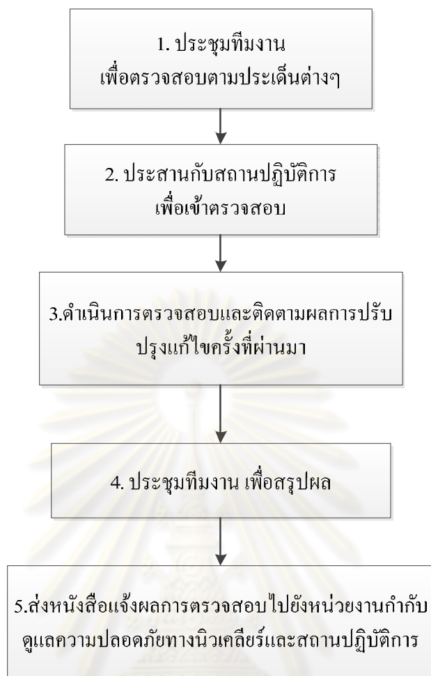
รูปที่ 1.4 การตรวจสอบสถานปฏิบัติการทางนิวเคลียร์
