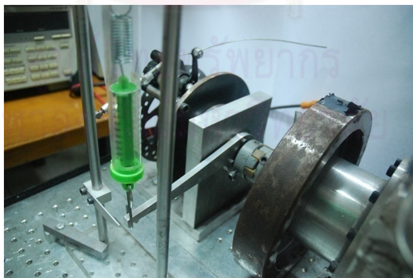
รูปที่ ก-4 การติดตั้งเครื่องมือวัดแรงบิด
