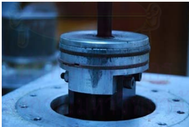
รูปที่ 4-11 ภาพของแหวนลูกสูบกำลังเมื่อใช้งานไป 40 ชั่วโมง
