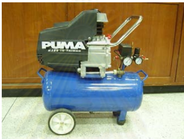
รูปที่ ก-7 ถังลมพร้อมกับอุปกรณ์ควบคุมแรงดันยี่ห้อ PUMA
