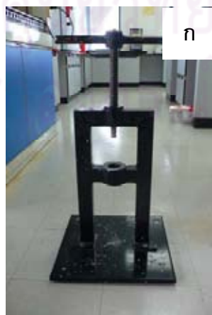
รูปที่ 3.1 อุปกรณ์อัดขึ้นรูปตัวเร่งปฏิกิริยา (ก) เครื่องอัดขึ้นรูป (ข) ชิ้นส่วนของเครื่องอัดขึ้นรูป
