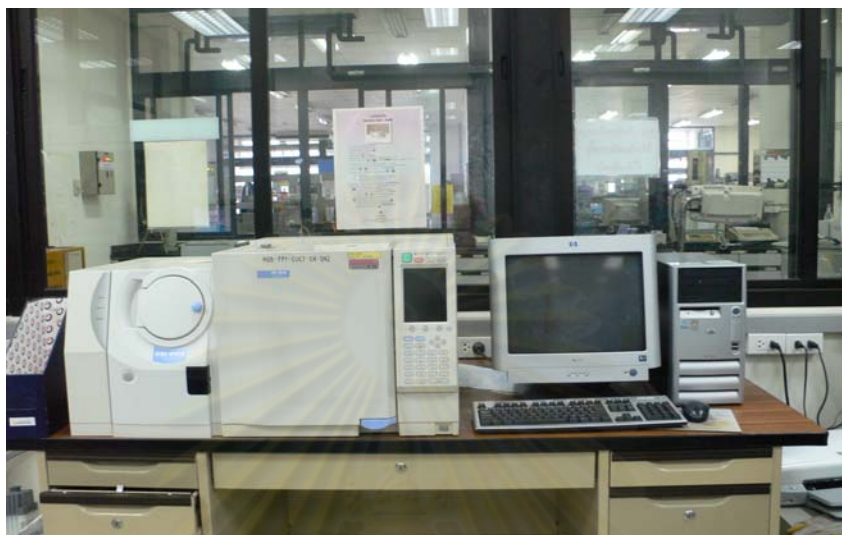
รูปที่ 3.7 เครื่องแก๊สโครมาโทกราฟกับแมสสเปกโตรมิเตอร์ (Gas Chromatograph with Mass Spectrometer), (GC-MS))
