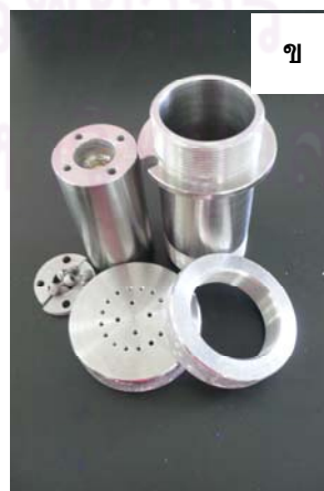
รูปที่ 3.1 อุปกรณ์อัดขึ้นรูปตัวเร่งปฏิกิริยา (ก) เครื่องอัดขึ้นรูป (ข) ชิ้นส่วนของเครื่องอัดขึ้นรูป
