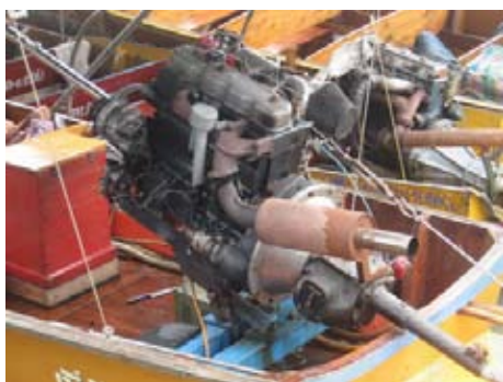
ภาพที่ 2.1 เรือต่อใช้เครื่องยนต์ซึ่งใช้เครื่องที่ถอดจากรถสปีดล้อย
