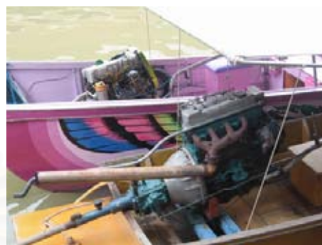
ภาพที่ 2.1 เรือต่อใช้เครื่องยนต์ซึ่งใช้เครื่องที่ถอดจากรถสปีดล้อย
