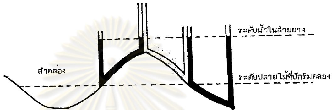
รูปที่ 7 แสดงการวัดความลาดเอียงของพื้นป่าในแต่ละแนว
