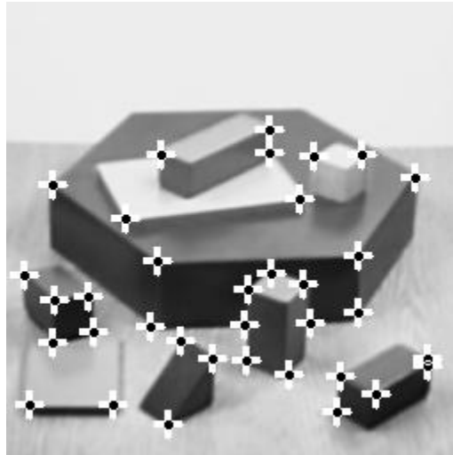
ภาพที่ 2.19 การหาจุดเด่นชัดด้วย SUSAN operator ( t = 25 )
