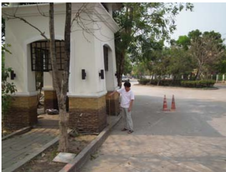
ภาพที่ 4-52 รูปถ่ายน้ำท่วม H = 1.00 ม.
