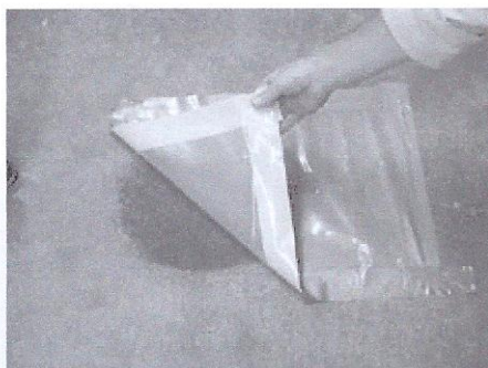
ภาพที่ 2-27 วิธีทดสอบความชื้นพื้นปูน
