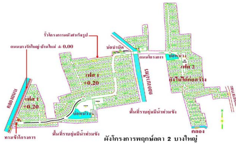
ภาพที่ 5-49 รูปถ่ายผังแสดงระดับในโครงการ
