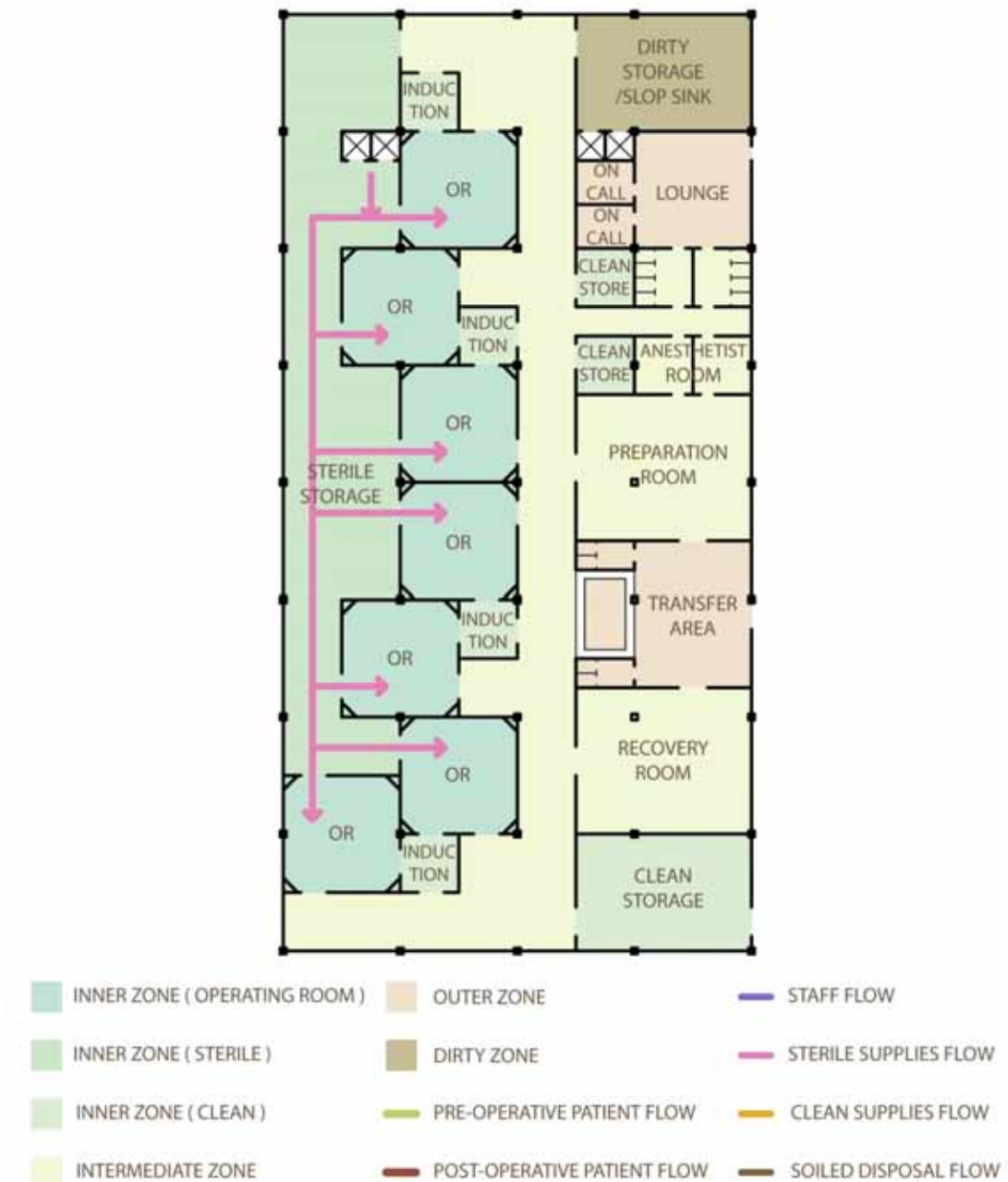
ภาพที่ 2-43 แสดงเส้นทางสัญจรของอุปกรณ์เครื่องมือปลอดเชื้อ บนการวางผังเส้นทางสัญจรแบบ Double Corridor Style (DCS)
