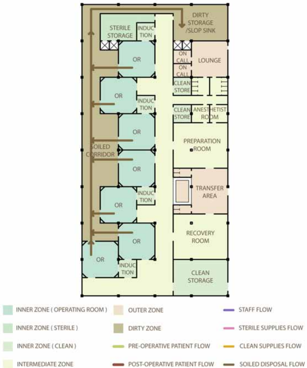
ภาพที่ 2-28 แสดงเส้นทางการสัญจรของอุปกรณ์เครื่องมือสกปรก บนผังเส้นทางการสัญจรแบบ Double Corridor Alternative With Surrounding Soiled Corridor Style (SSC)
