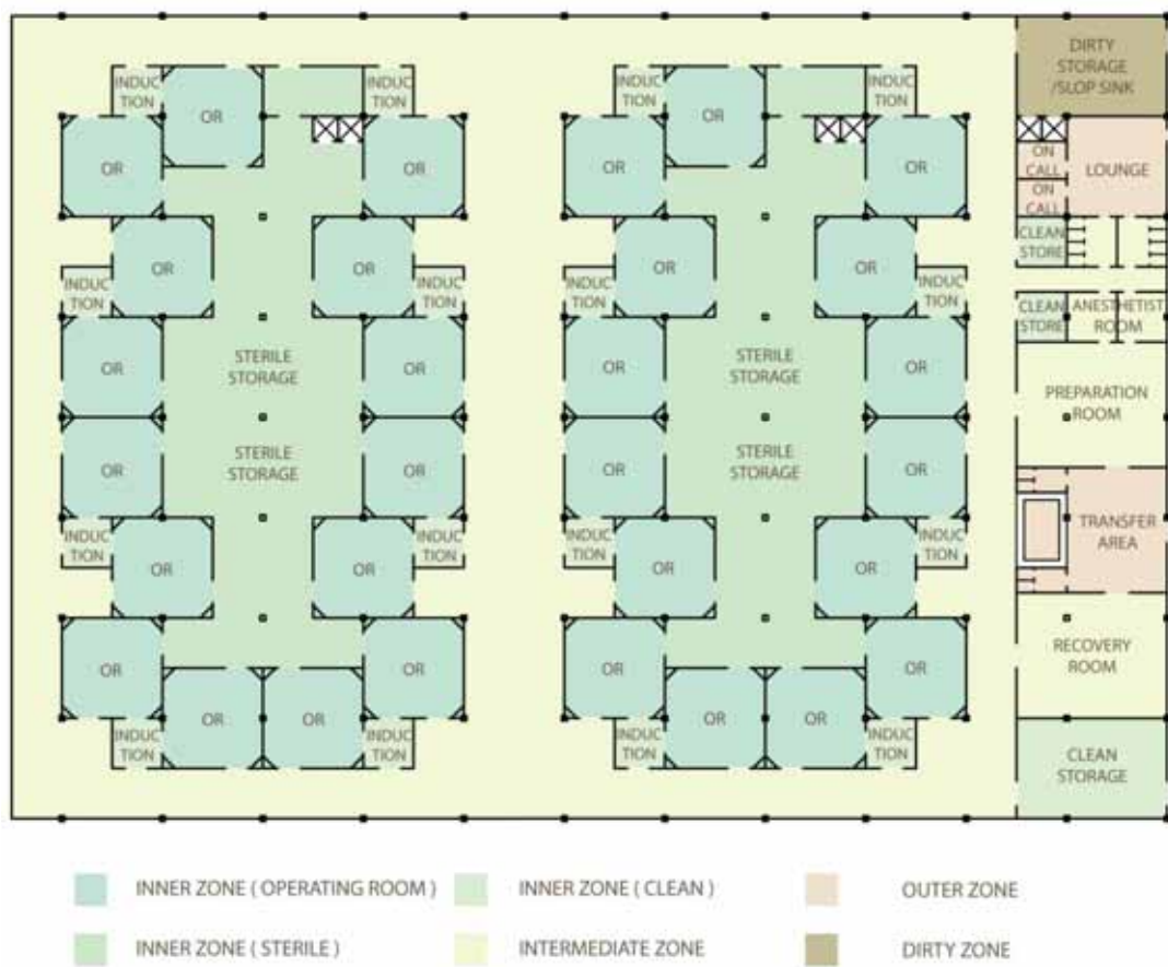
ภาพที่ 2-38 แสดงรูปแบบการวางผังเส้นทางสัญจรในหน่วยงานผ่าตัดแบบ Cluster Combination Peripheral Corridor Style
