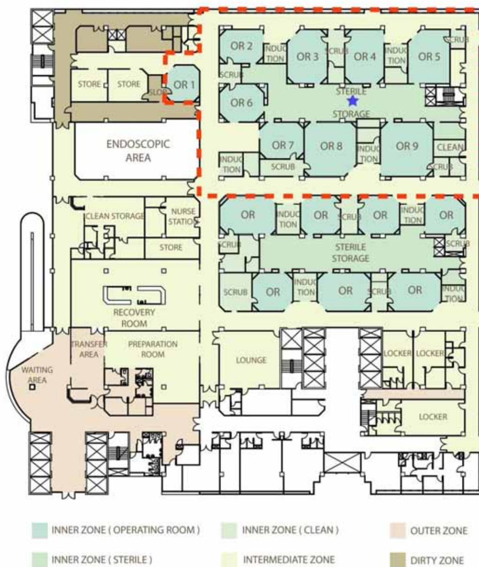
ภาพที่ 5-12 แสดงตำแหน่งห้องเก็บอุปกรณ์เครื่องมือปลอดเชื้อ และห้องผ่าตัดแต่ละห้องภายใต้เส้นประสีแดง หน่วยงานผ่าตัด ภาควิชาออร์โธปิดิกส์ อาคารสยามินทร์ โรงพยาบาลศิริราช
