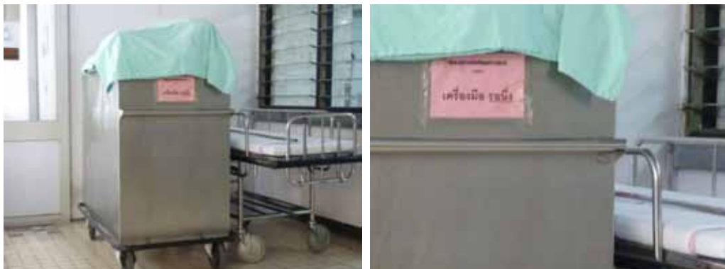
ภาพที่ 4-79 แสดงรถเข็นที่มีลักษณะปิดมิดชิดสำหรับบรรจุอุปกรณ์เครื่องมือที่ Wash และ Pack เรียบร้อยแล้วจากห้อง Pack เพื่อนำไปยังหน่วยจ่ายกลางทำการอบฆ่าเชื้อต่อไป
