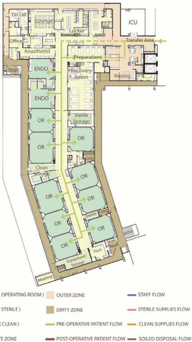
ภาพที่ 4-36 แสดงเส้นทางสัญจรของผู้ป่วยก่อนการผ่าตัด หน่วยงานผ่าตัด ภาควิชาศัลยศาสตร์ อาคาร 1 โรงพยาบาลรามารินทร์
