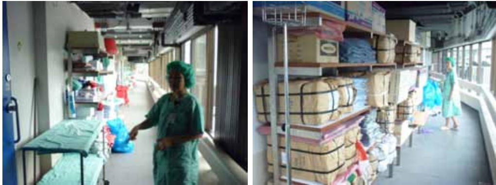
ภาพที่ 4-73 แสดงเส้นทางสัญจรสกปรกแบบปิด เจ้าหน้าที่บุคลากรที่จะอยู่บนเส้นทางนี้จะมีเพียงคนงานเท่านั้น เพื่อทำหน้าที่จัดการอุปกรณ์เครื่องมือใช้แล้ว และทำความสะอาดห้องผ่าตัดหลังการผ่าตัดเพื่อเตรียมพร้อมสำหรับผู้ป่วยรายต่อไป
