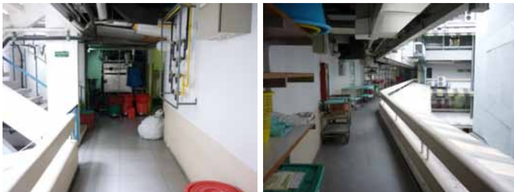
ภาพที่ 4-76 แสดงเส้นทางสัญจรสกปรกแบบเปิดเชื่อมต่อกับภายนอก หลังห้องผ่าตัดที่เชื่อมกับเส้นทางสัญจรสกปรกประเภทนี้จำเป็นต้องมีห้อง Slop Sink กั้นก่อนออกสู่ภายนอก เจ้าหน้าที่บุคลากรที่จะอยู่บนเส้นทางนี้จะมีเพียงคนงานเท่านั้น
