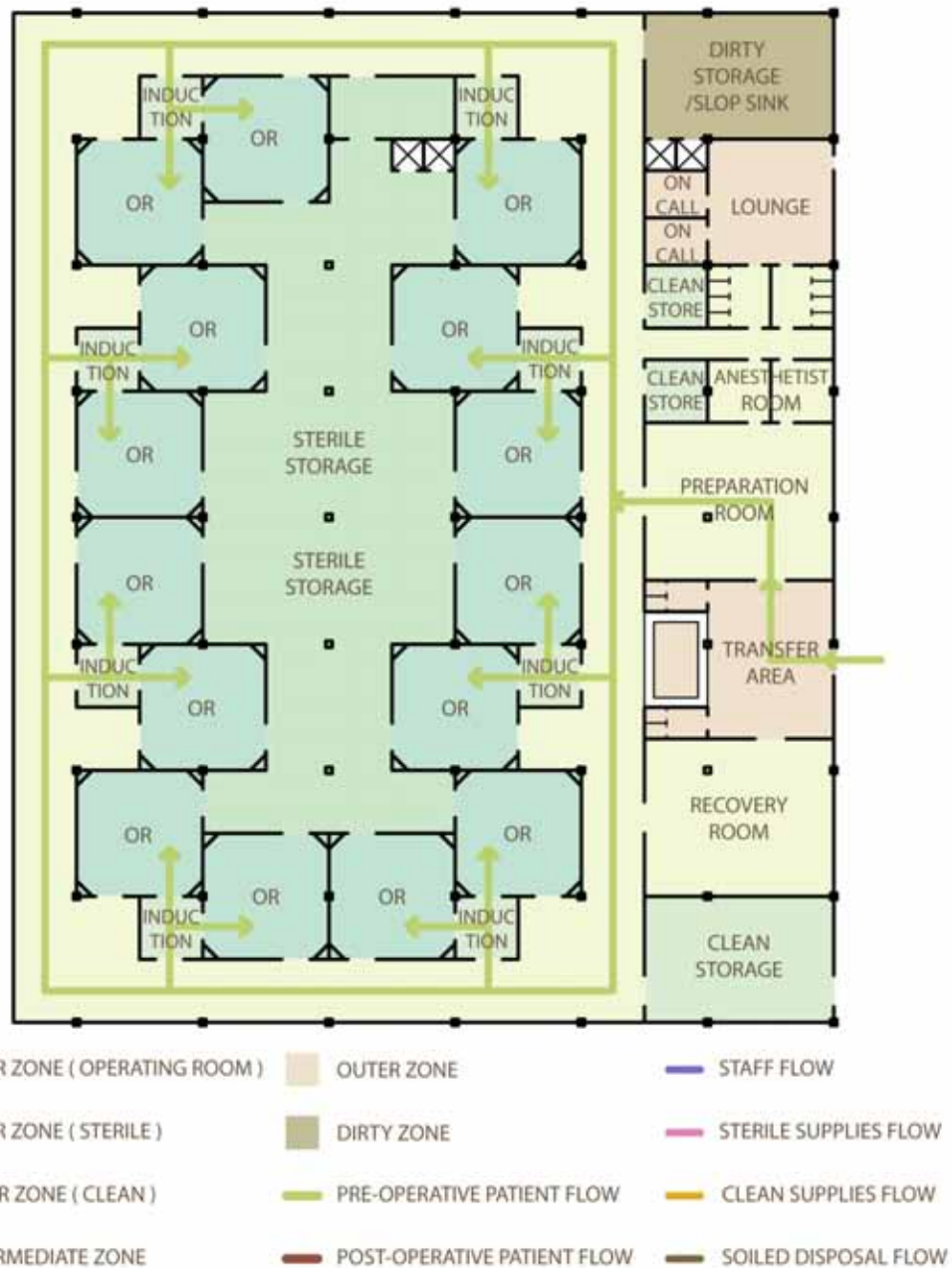
ภาพที่ 2-32 แสดงเส้นทางสัญจรของผู้ป่วยก่อนการผ่าตัด บนการวางผังเส้นทางสัญจรแบบ Peripheral Corridor Style (PCS)
