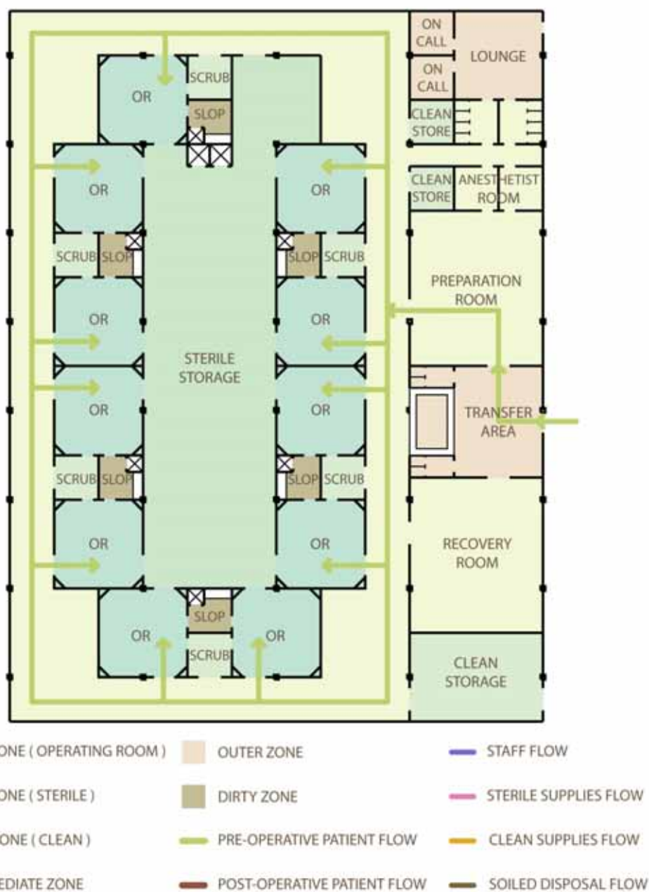
ภาพที่ 6-2 แสดงเส้นทางสัญจรของผู้ป่วยก่อนการผ่าตัด บนการวางผังเส้นทางสัญจรแบบ Vertical Corridor Style (VCS)
