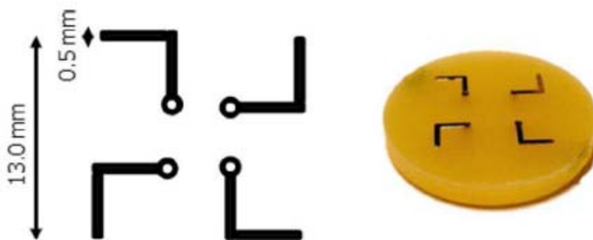
ภาพที่ 2.1 โครงสร้างของไครัลบนพีซีบอร์ด
