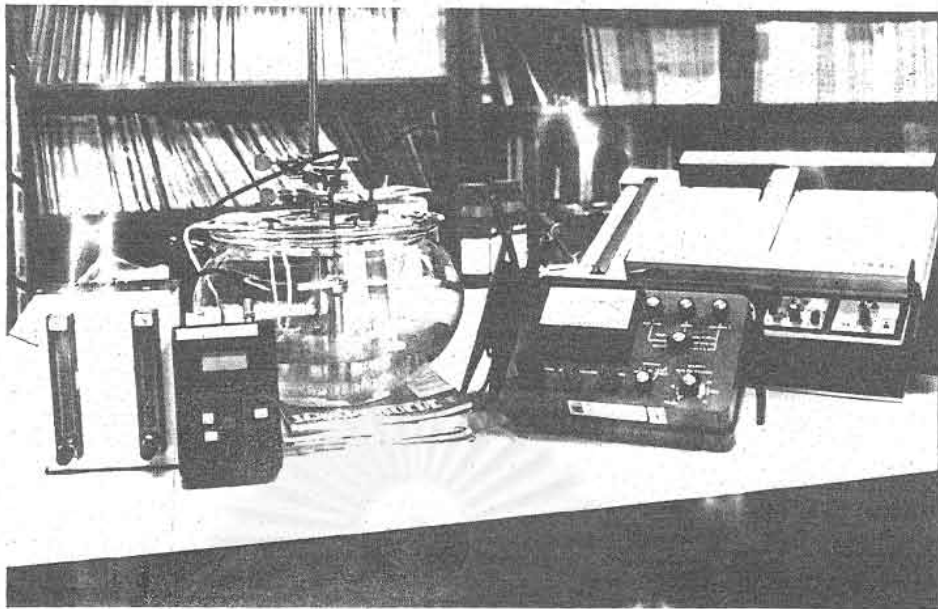
รูปที่ 4.2 ระบบที่ใช้ในการวัดและทดสอบหัววดออกซิเจนที่พัฒนาขึ้น
