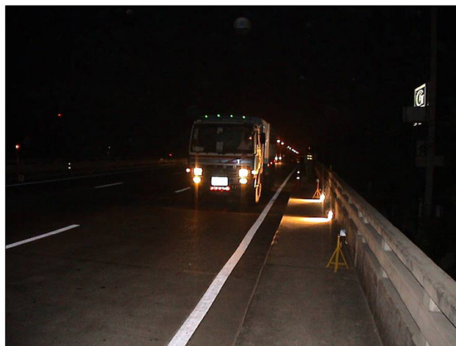
ภาพที่ 3.13 ลักษณะการติดตั้งเซ็นเซอร์บอกตำแหน่งรถเข้าและออก
