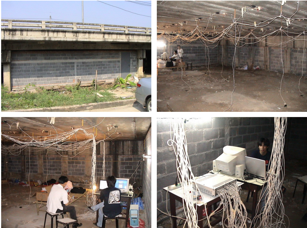
ภาพที่ 3.5 ตัวอย่างภาพตำแหน่งติดตั้งอุปกรณ์วัดความเครียดได้สะพาน
