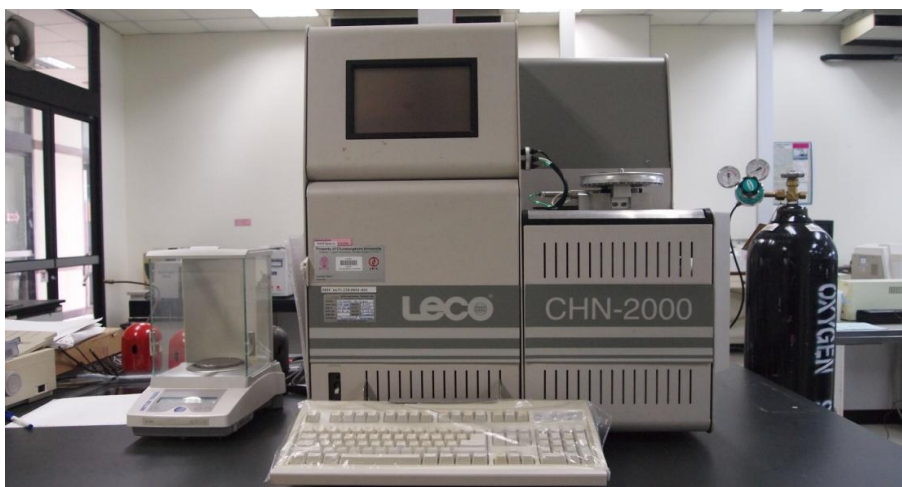
รูปที่ 3.8 เครื่องวิเคราะห์ธาตุ CHN ยี่ห้อ LECO รุ่น CHN2000
