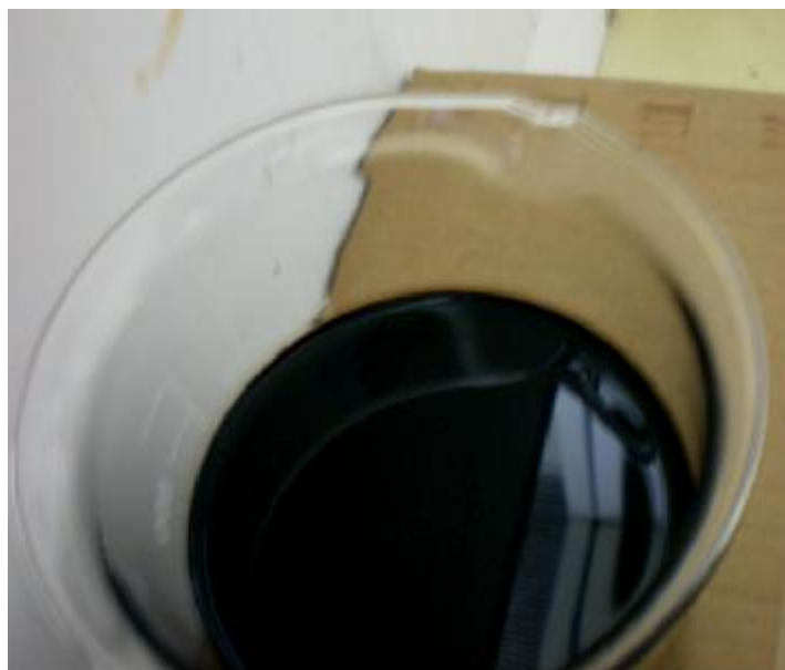
รูปที่ 37 น้ำทิ้งจากกระบวนการชุบด้วยแพลเลเดียม
