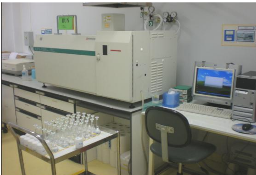
รูปที่ 3.6 เครื่อง ICPS-7000 ใช้วิเคราะห์หาปริมาณไอออนโลหะ
