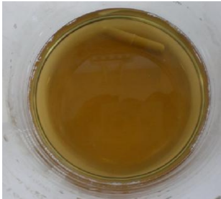
รูปที่ 39 สารละลายป้อนหลังจากการกรองด้วยเครื่องกรองระบบสุญญากาศ
