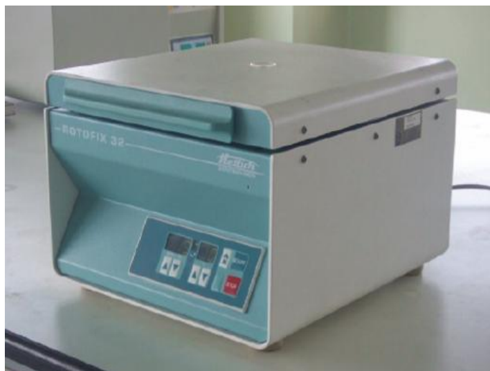
รูปที่ 34 เครื่องปั่นเหวี่ยงแยกตะกอน (Centrifuge รุ่น ROTOFIX 32A)
