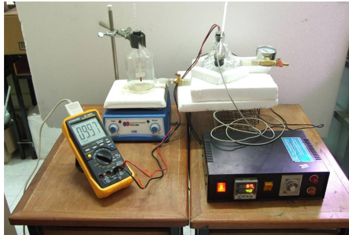
รูปที่ 3.3 ภาพถ่ายอุปกรณ์สำหรับทดลองวัดค่าการเปลี่ยนแปลงความต้านทานของตัวตรวจวัดก๊าซ
