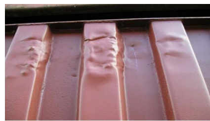
ภาพที่ 2.31 แสดงภาพผนังตู้คอนเทนเนอร์ที่มีความไม่เหมาะสมเกิดจากการยัดตัวของแผ่นเหล็ก
