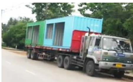
ภาพที่ 5.45 แสดงภาพรถพ่วง 18 ล้อที่ใช้ขนส่งตู้คอนเทนเนอร์ 1
