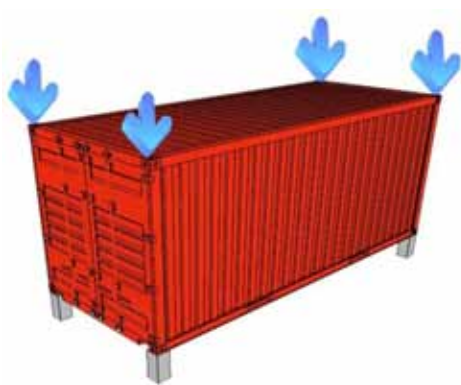
ภาพที่ 6.1 แสดงลักษณะการรับแรงของตู้คอนเทนเนอร์
