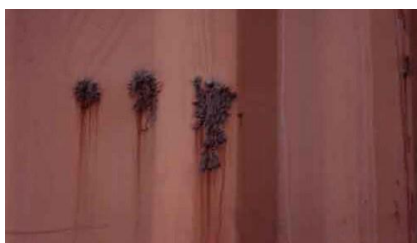
ภาพที่ 2.38 แสดงภาพร่องรอยการกัดกร่อนของสนิม 1
