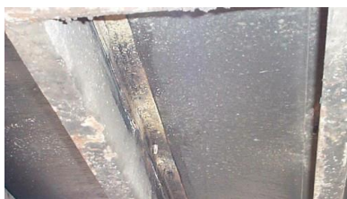
ภาพที่ 2.69 แสดงภาพการเชื่อมตะเข็บบริเวณด้านข้างของ crossmember
