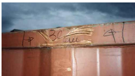
ภาพที่ 2.46 แสดงภาพรอยบุบของโครงสร้างเฟรมส่วนบนของตู้คอนเทนเนอร์
