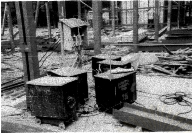
ภาพที่ 4-76 เครื่องเชื่อมขนาด 300 แอมแปร์ ชนิดแรงดันคงที่แบบปรับกระแสไฟฟ้าได้
