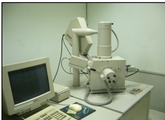
ภาพที่ 3.8 กล้องจุลทรรศน์อิเล็กตรอนแบบส่องกราดรุ่น XL 30 CP บริษัท PHILIPS ประเทศเนเธอร์แลนด์
