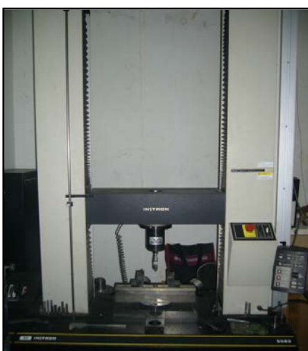
ภาพที่ 3.12 เครื่อง Universal testing machine รุ่น 5538 บริษัท Instron ประเทศสิงคโปร์
