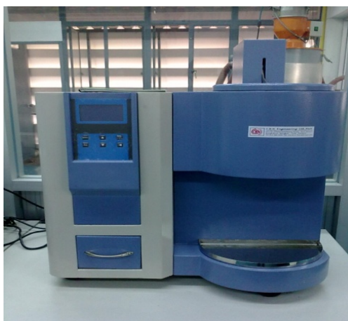
ภาพที่ 3.10 เครื่อง Melt flow index รุ่น XRL-400 series บริษัท C.B.N.Engineering Ltd.,Part ประเทศจีน
