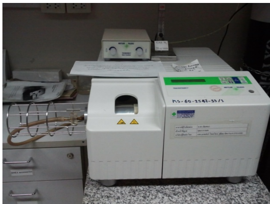
ภาพที่ 3.9 เครื่อง Thermal Gravimetric Analysis (TGA) รุ่น TGA/SDTA 851 บริษัท METTLER TOLEDO
