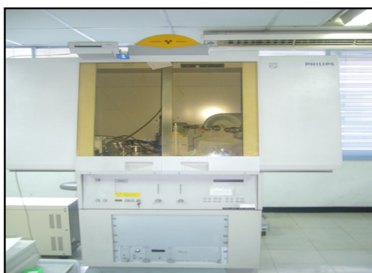
ภาพที่ 3.6 เครื่อง X-ray Diffractometer รุ่น X'Pert PW 3710 บริษัท PHILIPS ประเทศไทย
