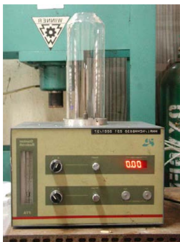
ภาพที่ 3.13 เครื่องวิเคราะห์ดัชนีออกซิเจนจำกัดของ Stanton Redcroft รุ่น FTA
