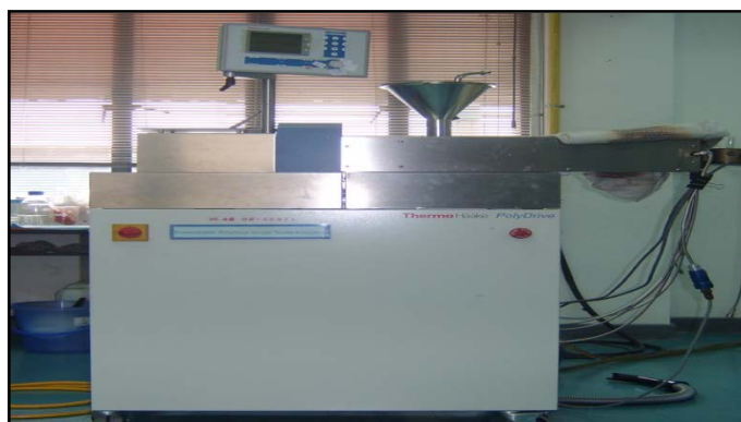
ภาพที่ 3.3 เครื่องปั่นเส้นใยแบบหลอมเหลวชนิด Single Screw ยี่ห้อ Thermo Haake
