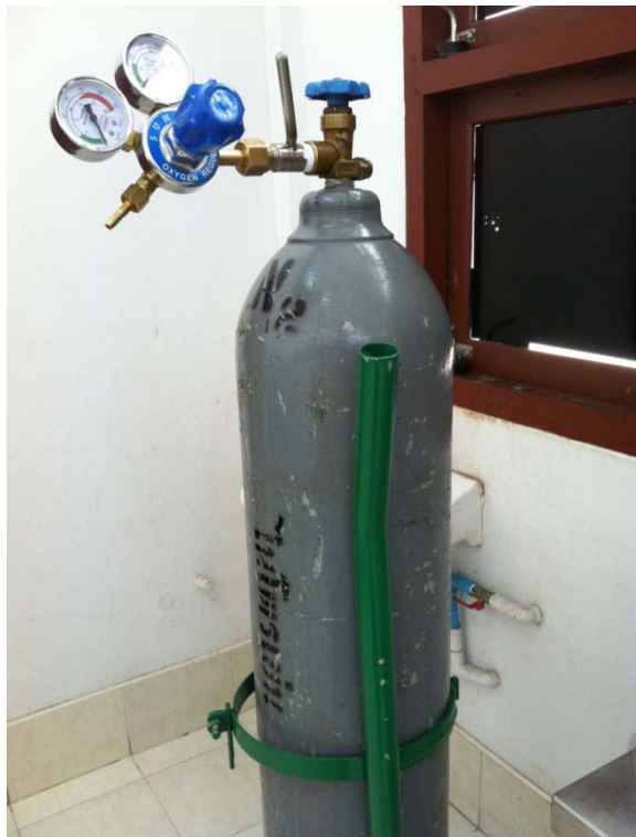
ภาพที่ 3.6 แสดงถังก๊าซไนโตรเจนที่ใช้ในการสร้างสภาวะจำลองของ chronic intermittent hypoxia
