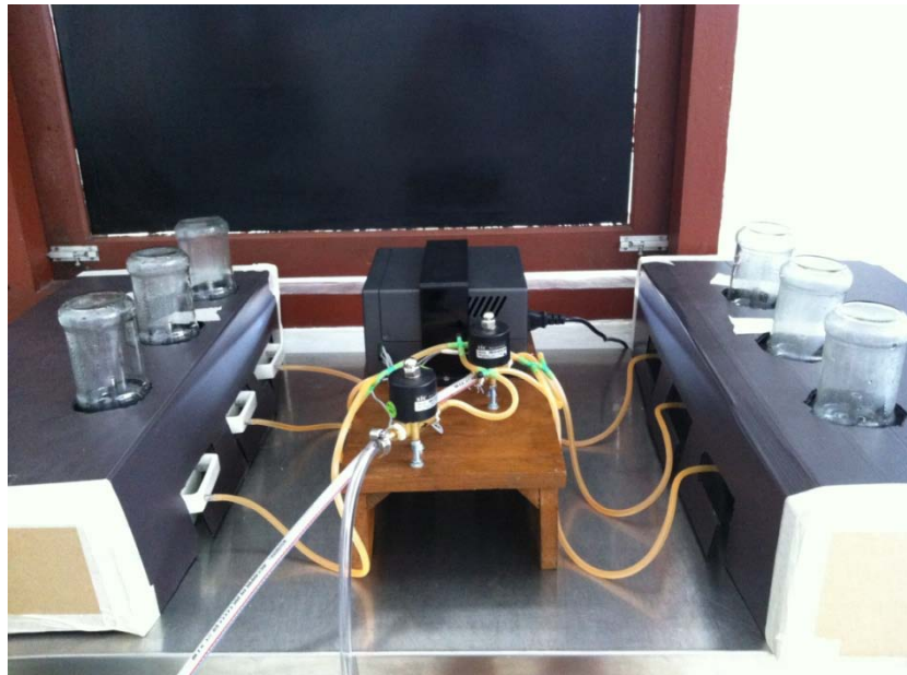
ภาพที่ 3.8 แสดงการทำภาวะจำลองของ chronic intermittent hypoxia ในช่วง light phase ในระบบปิด (จำลองช่วงนอนหลับของหนูแรท)
