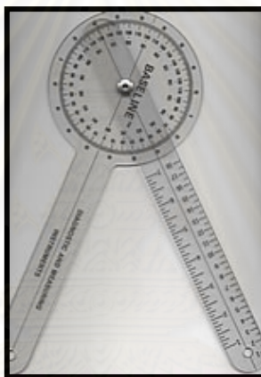
รูปที่ 4. แสดงอุปกรณ์ที่ใช้ในการวัดมุม goniometer
