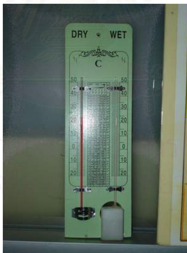
ภาพที่ 3.4 แสดงเครื่องวัดอุณหภูมิและความชื้นสัมพัทธ์
