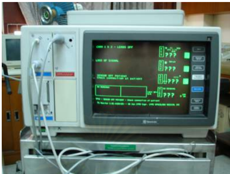
ภาพที่ 3.3 แสดงเครื่องวัดความอิ่มตัวของออกซิเจนในหลอดเลือดแดง (Pulse oximeter) และวัดคลื่นไฟฟ้าหัวใจ (Electrocardiogram) ของ SpaceLabs
