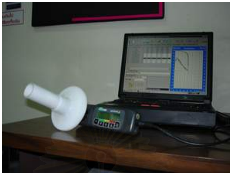
ภาพที่ 3.1 แสดงเครื่องวัดสมรรถภาพการทำงานของปอดของ Spirobank
