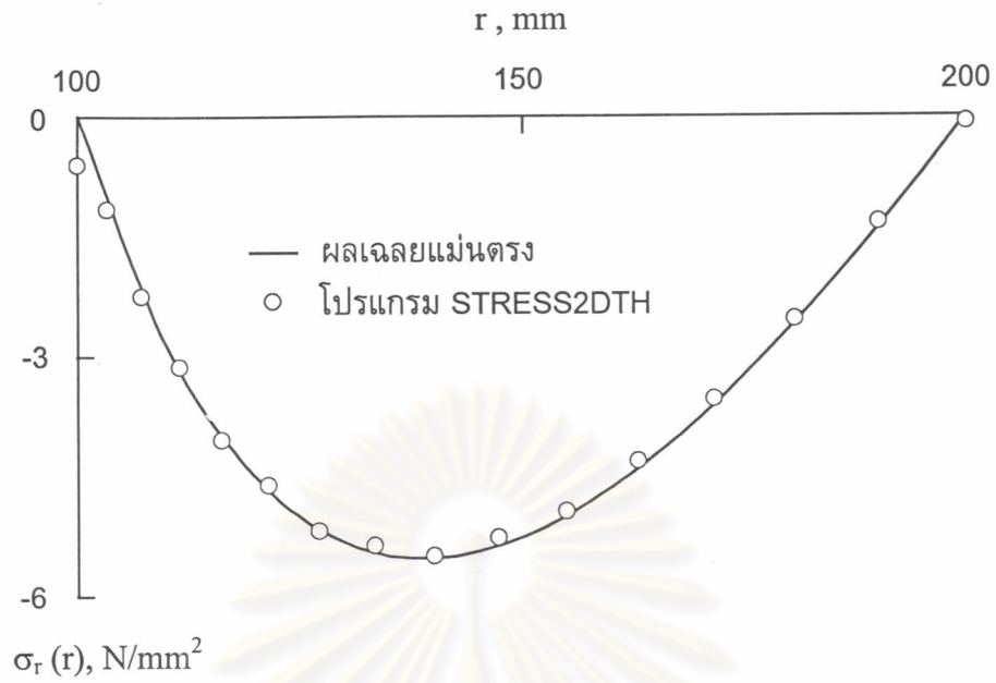
รูปที่ 6.45 ความเค้นในแนวรัศมี \sigma_r ตามทิศทางรัศมีที่แนวมุม \theta เท่ากับ 0
