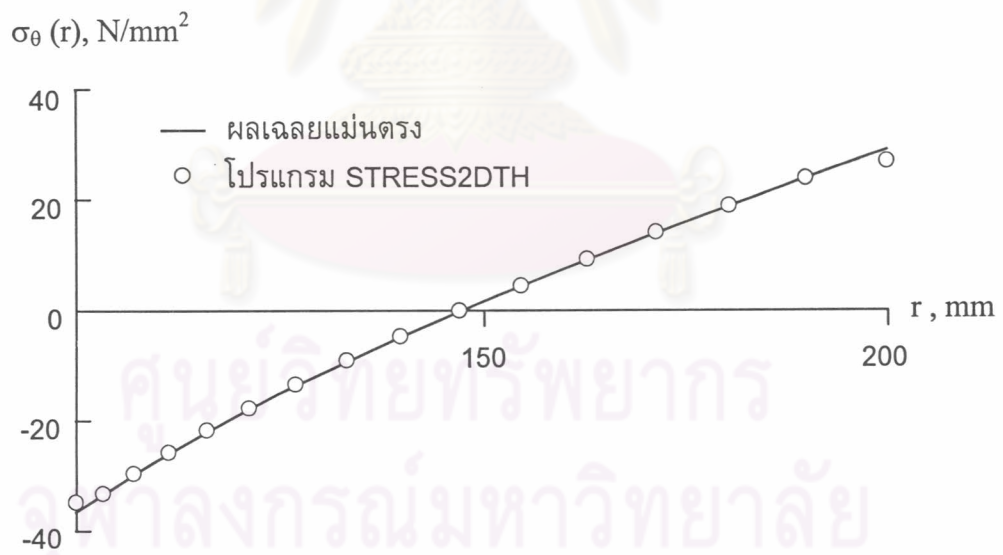
รูปที่ 6.46 ความเค้นในทิศ \theta , \sigma_\theta ตามทิศทางรัศมีที่แนวมุม \theta เท่ากับ 0
