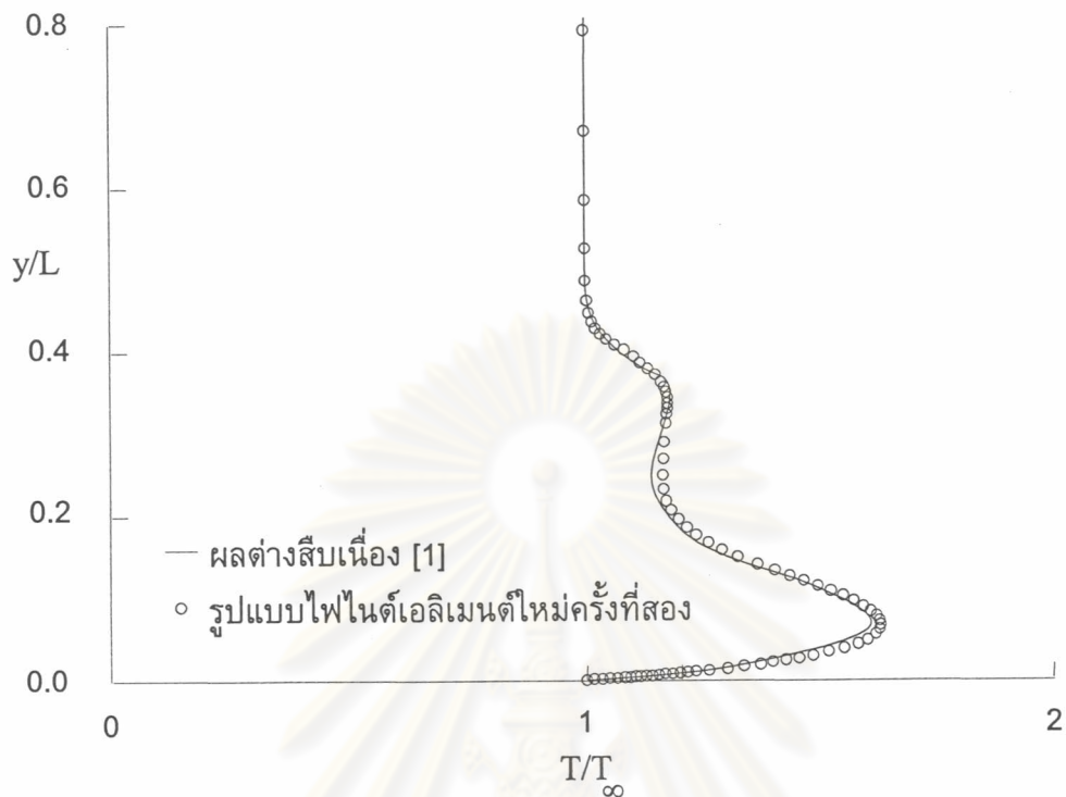
รูปที่ 6.31 การกระจายอุณหภูมิตลอดขอบเขตด้านกรไหลออก สำหรับปัญหาการไหลความเร็วสูงผ่านแผ่นเรียบปลายแหลม
