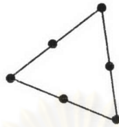
รูปที่ 3.10 รูปแสดงโหนดของจันประกอบรูปสามเหลี่ยมในการประมาณแบบกำลังสอง
