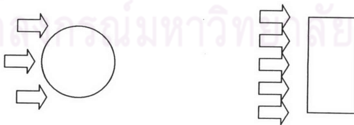
รูปที่ 2.4 แสดงทิศทางกระแสลมที่มากกระทบกับอาคารที่มีรูปทรงต่างกัน ซึ่งจะส่งผลต่อปริมาณการรั่วซึมของอากาศที่ต่างกันด้วย
