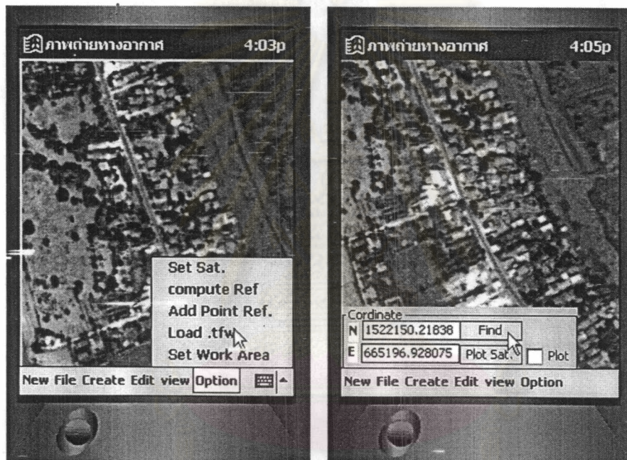
รูปที่ 3.5 แสดงการทำให้ภาพมีค่าพิกัดโดยใช้ไฟล์ค่าพิกัดชนิด world file
