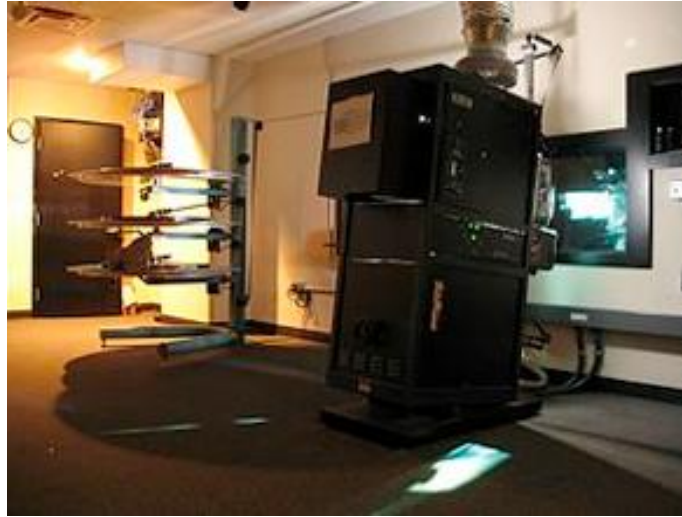
ภาพที่ 4.3 ระบบการฉายแบบใช้ฟิล์มโดยใช้ Platter
