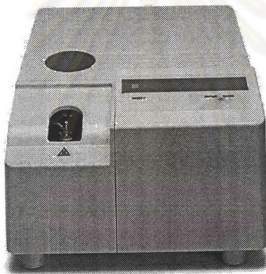
รูปที่ 3.8 ดิฟเฟอเรนเชียลสแกนนิ่งแคลอริมิเตอร์ เมทเธอร์-โทเลโด รุ่น DSC 822-e/400w
