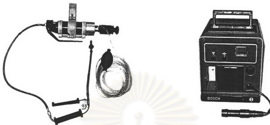
รูปที่ 3-17 ชุดเครื่องมือวัดค่าควันดำ ภาพซ้าย แสดงภาพปั๊มดูดไอเสีย รุ่น ETD 020.00 ภาพขวา แสดงภาพ เครื่องอ่านค่าควันดำ รุ่น ETD 020.50
