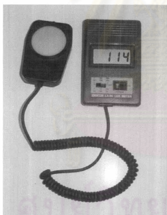
รูปที่ 3.9 แสดงเครื่องวัดความเข้มแสง (Lux meter) และสเปกตรัมแสดง Relative Sensitivity
