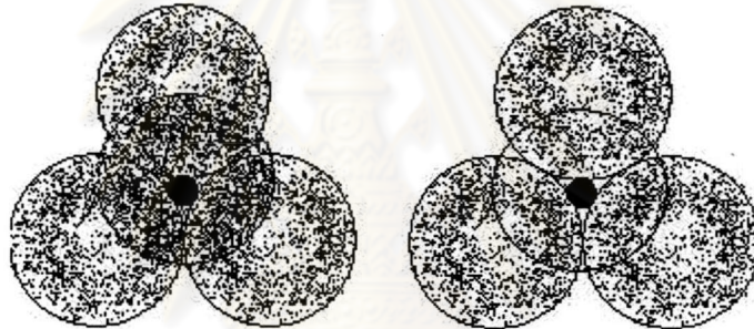
รูปที่ 2.1 โครงสร้างของซิลิกาในรูปแบบเตตระฮีดรอน
