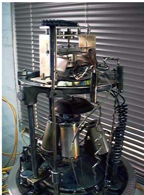
รูปที่ 3.5 ระบบการเตรียมฟิล์มบาง CIGS ภายในภาชนะสุญญากาศ
