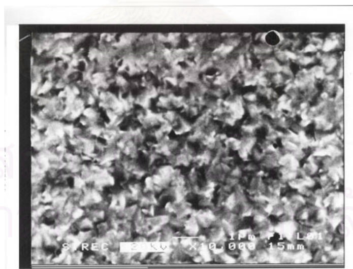
รูปที่ 5.36 แสดงลักษณะผิวหน้าของฟิล์มบาง CIGS127 ที่ถ่ายจากกล้อง SEM ตำแหน่งที่ 5
