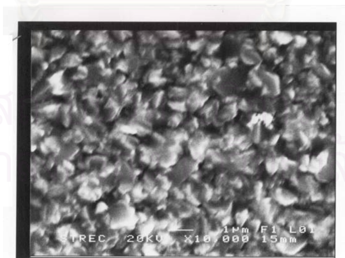
รูปที่ 5.30 แสดงลักษณะผิวหน้าของฟิล์มบาง CIGS125 ที่ถ่ายจากกล้อง SEM ตำแหน่งที่ 3
