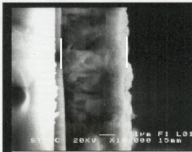
รูปที่ 5.23 แสดงลักษณะภาคตัดขวางของฟิล์มบาง CIGS109 ที่ถ่ายจากกล้อง SEM ตำแหน่งที่ 1
