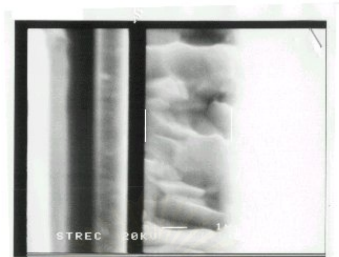
รูปที่ 5.15 แสดงลักษณะภาคตัดขวางของฟิล์มบาง CIGS82 ที่ถ่ายจากกล้อง SEM ความหนา 3.3 \mu\text{m}
