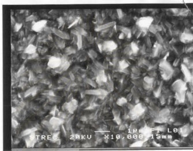
รูปที่ 5.10 แสดงลักษณะผิวหน้าของฟิล์มบาง CIGS81 ที่ถ่ายจากกล้อง SEM ตำแหน่งที่ 2 มีค่า
