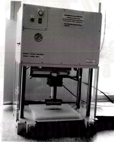
รูปที่ 3.10 เครื่องตัดตัวอย่างยางแบบใช้กำลังลม
