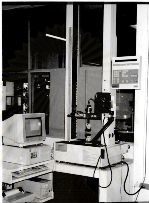
รูปที่ 3.11 เครื่องทดสอบความต้านทานแรงดึง
