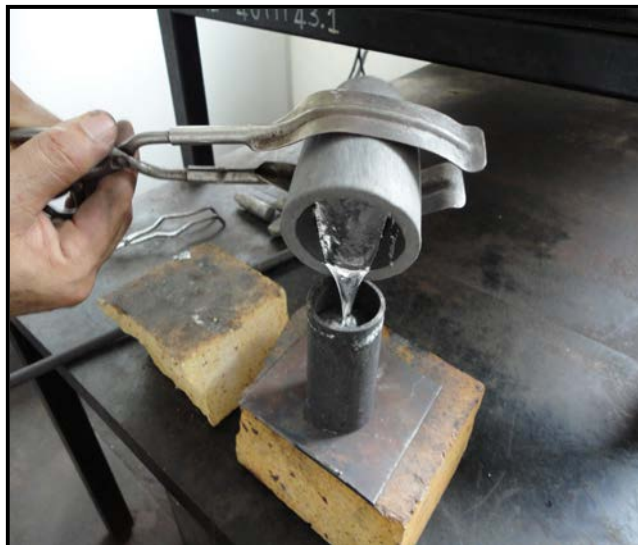
ภาพที่ 3.2 เทโลหะผสมหลอมเหลวลงในแม่พิมพ์ทรงกระบอก
