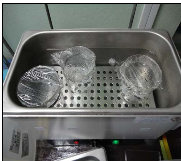
ภาพที่ 3.4 แช่ชิ้นงานสังกะสีในอ่างน้ำ
