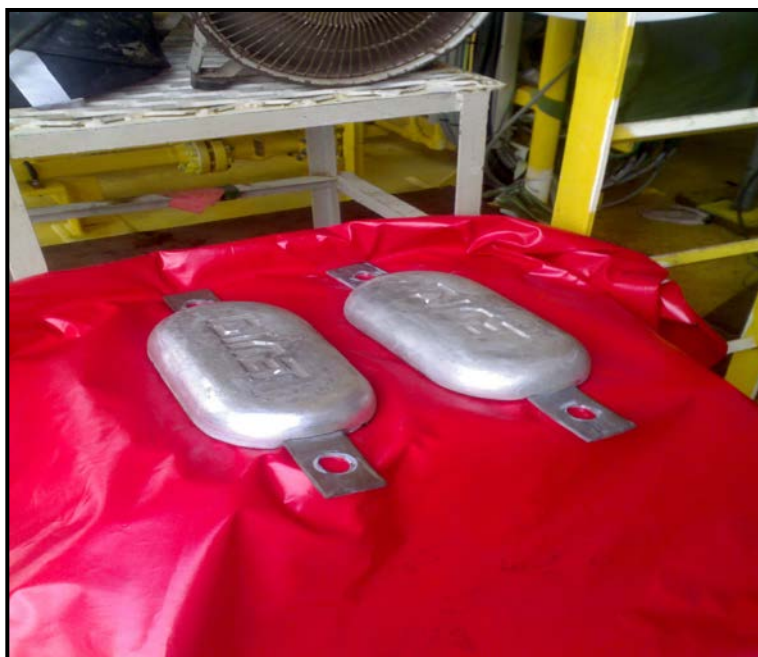
ภาพที่ 2.1 สังกะสีกันกร่อนน้ำหนัก 10 กิโลกรัมที่ใช้ป้องกันการกัดกร่อนของท่อขนาดใหญ่บนแท่นขุดเจาะน้ำมัน
