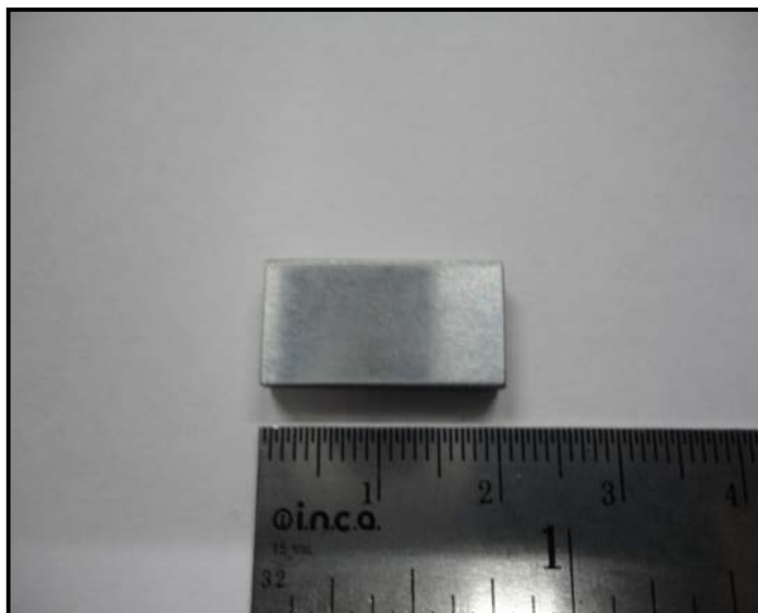
ภาพที่ 3.3 ชิ้นงานที่ได้จากการตัดด้วยวิธีการกัดเซาะโลหะด้วยตัวนำไฟฟ้า
