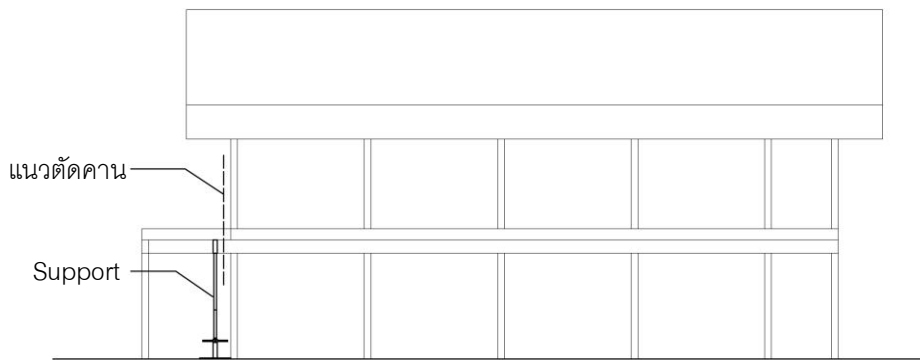
รูป 5-10 ภาพจำลองการทำSupportบริเวณจุดเชื่อมต่อ
