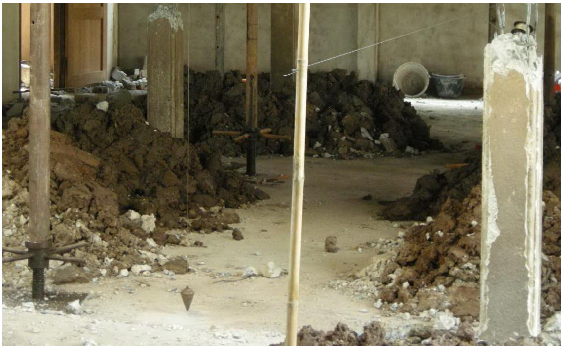
รูปที่ 4-49 การติดตั้งอุปกรณ์วัดระดับแนวขวาง
