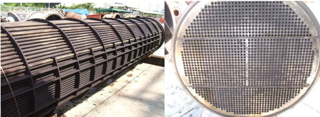
รูปที่ 2.2 เครื่องแลกเปลี่ยนความร้อนแบบเชลล์และท่อที่ใช้ในกระบวนการกลั่นน้ำมันดิบ (อ้างอิงจาก เครื่องแลกเปลี่ยนความร้อนของบริษัทไออาร์พีซี จำกัด(มหาชน))
