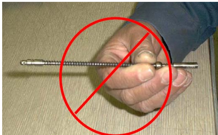
ภาพที่ ก-3 วัสดุกัมมันตรังสี Ir-192 ภายในเครื่องถ่ายภาพด้วยรังสีทางอุตสาหกรรม ที่มีความอันตรายมากและห้ามสัมผัสโดยเด็ดขาด [9]
