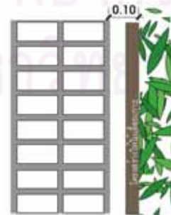
ผนังก่ออิฐฉาบปูน 2 ชั้น หนา 20 ซม. ปกคลุมด้วยดินพวงแสด
