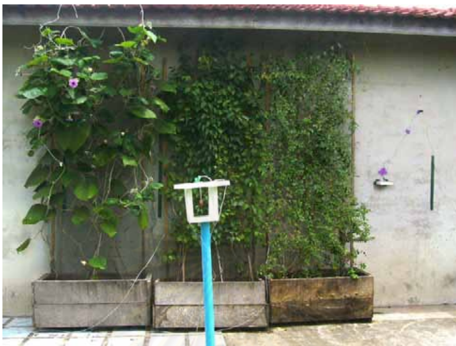
ภาพที่ 3.38 แสดงการติดตั้งเครื่องมือบันทึกข้อมูลบริเวณผิวนั่ง ภายนอกอาคารผนัง
