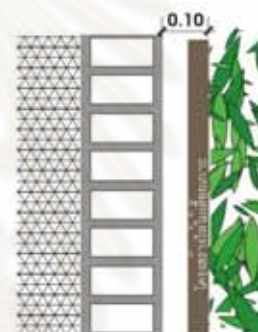
ผนังก่ออิฐฉาบปูน หนา 10 ซม.บุโฟม โพลีสไตรีนหนา 3 นิ้ว ปกคลุมด้วยดินพวงแสด
