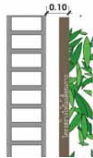
ผนังก่ออิฐฉาบปูน หนา 10 ซม. ปกคลุมด้วยดินพวงแสด
