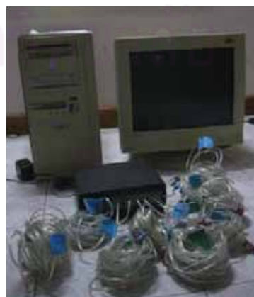
ภาพที่ 3.25 หัววัด SHT15 และการต่อเข้ากับคอมพิวเตอร์เพื่อบันทึกข้อมูล
