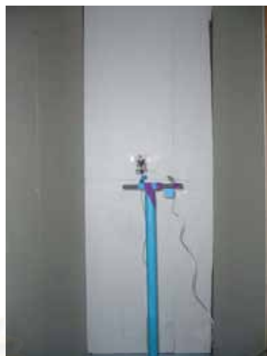
ภาพที่ 3.35 แสดงการติดตั้งเครื่องมือบันทึกข้อมูล ภายในห้องทดลองที่เพิ่มความต้านทานความร้อน ด้วยโฟมหนา 3 นิ้ว
