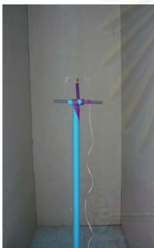
ภาพที่ 3.36 แสดงการติดตั้งเครื่องมือบันทึกข้อมูล ภายในห้องทดลองผนังซีเมนต์บอร์ด
