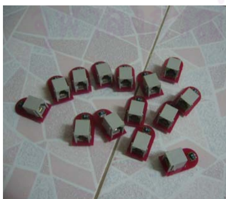
ภาพที่ 3.25 หัววัด SHT15 และการต่อเข้ากับคอมพิวเตอร์เพื่อบันทึกข้อมูล
