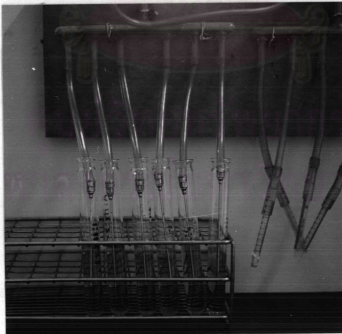
รูปที่ 2 การไล่อากาศจากหลอดอาหารเลี้ยงเชื้อเหลวโดยใช้แก๊สไนโตรเจน (OFN)
