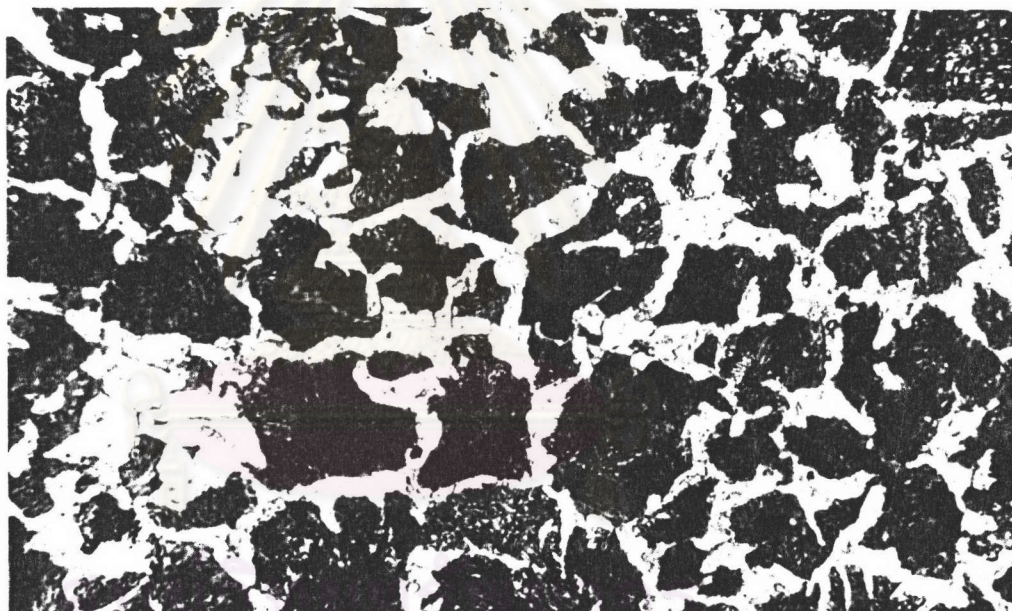
รูปที่ 5.49 โครงสร้างทางโลหะวิทยาของเหล็กประเภทที่ 1 (S50C) ก่อนการชุบแข็ง (ภาพขยาย 200 เท่า)
