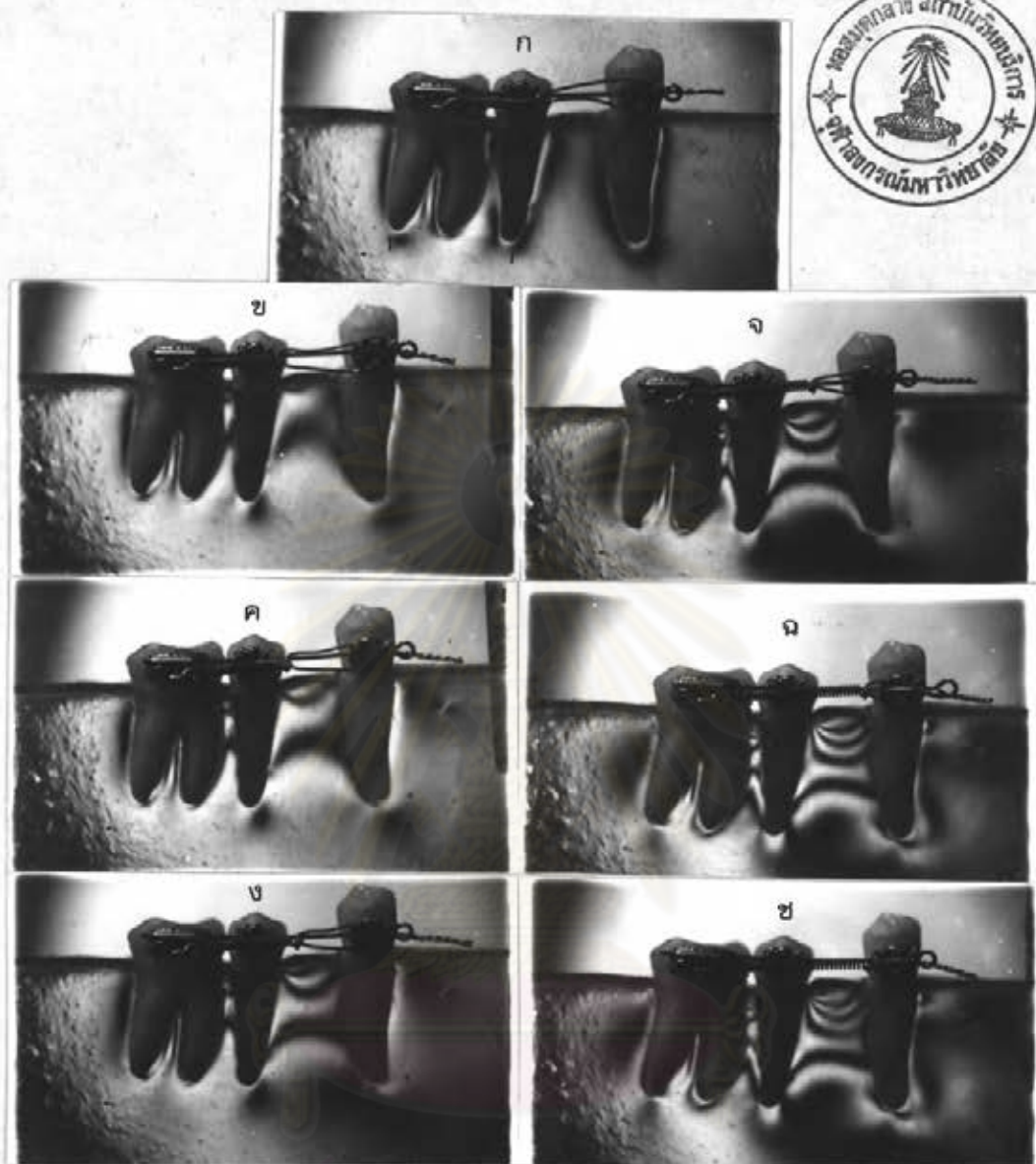
รูปที่ 74 แสดงการกระจายของความเค้นที่เกิดขึ้นในฟันเขี้ยว ภาย เครื่องมือชนิดสปริงชนิดเกลียวปิด ขนาด 0.009 x 0.030 นิ้ว วัตต์ ฟิล แรงที่น้ำหนักกระตุ่น ดังนี้
