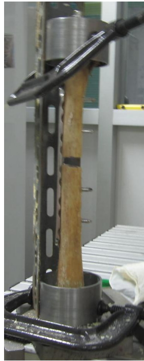
รูปที่ 10 แสดงการยึดตรึงกระดูกเข้ากับ plate screw และฐานรับกระดูก
