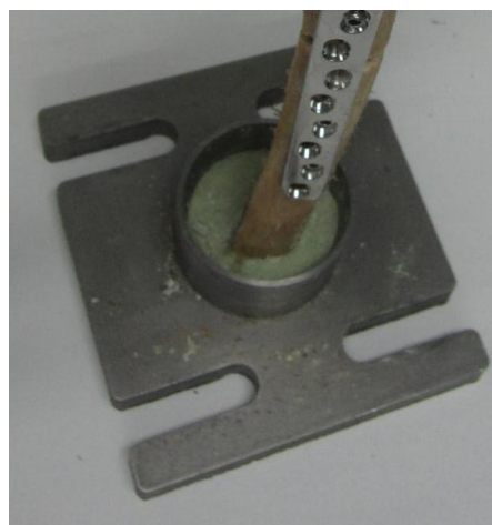
รูปที่ 16 ภาพแสดงการยึดฐานรับกระดูกเข้ากับกระดูกด้วย bone cement
