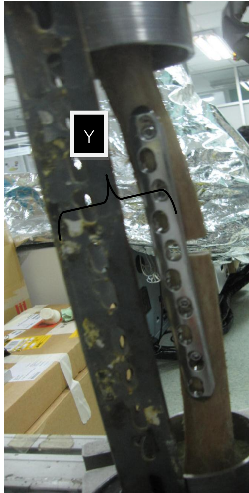
รูปที่ 15 แสดงการวัดระยะการตั้งการทดสอบเข้ากับแนวแกนในระยยะ y
