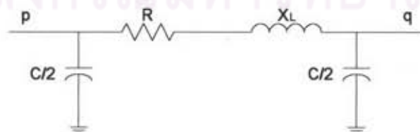
รูปที่ 2.2 วงจรสมมูลพายที่ใช้แทนสายส่งไฟฟ้า
