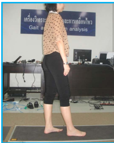
รูปที่ 2.11 การวัดแรงกดในฝ่าเท้าด้วย Force plate ของเครื่อง RS scan
