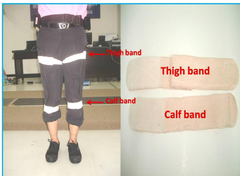
รูปที่ 3.24 แถบผ้ารัดสายไฟตรงต้นขา (Thigh bands) และน่อง (Calf band)
