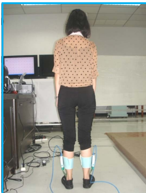
รูปที่ 2.12 การวัดแรงกดในฝ่าเท้าด้วยเครื่อง F-scan
