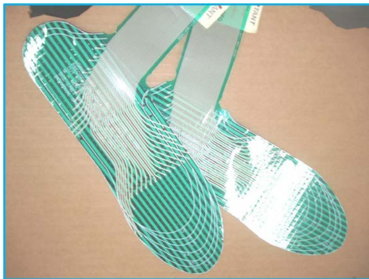
รูปที่ 2.13 แผ่นรองเท้าที่ใช้ในการวัดแรงของเครื่อง F-scan
