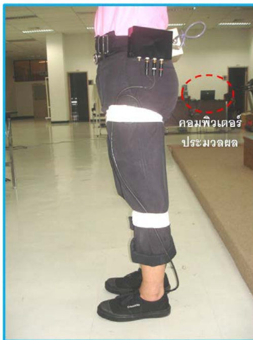
รูปที่ 1.3 การสื่อสารระหว่างกล่องประมวลผลกับคอมพิวเตอร์แสดงผล ด้วยการสื่อสารไร้สายผ่านบลูทูธโมดูล
