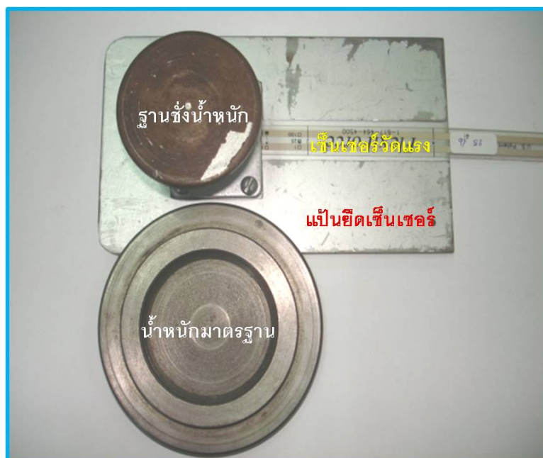
รูปที่ 3.9 อุปกรณ์ในการปรับเทียบการทำงานของเซนเซอร์วัดแรง
